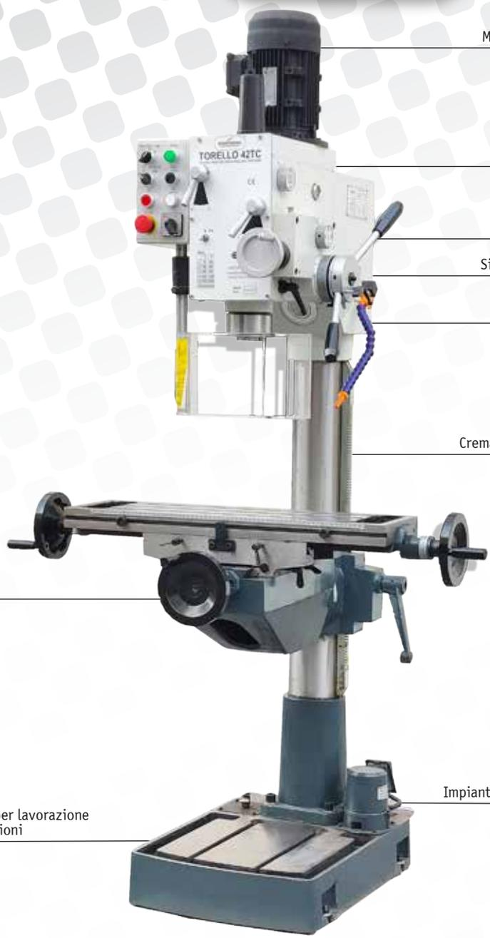
Motore a 2 velocità 1,1 kW / 1,5 kW
